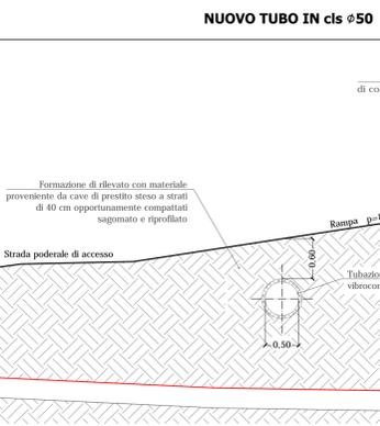
**PARTICOLARI SISTEMAZIONE FOSSO IDRICO RICETTORE - Scala 1:50**
